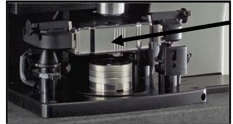
Fig. 1 La testa Crystal Scanner TM all'interno del Microscopio AFM NanoR 2
