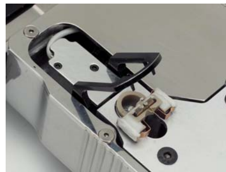
Fig. 3 Montaggio del sensore nel modulo di forza a inserzione zero utilizzato nel Crystal Scanner TM
